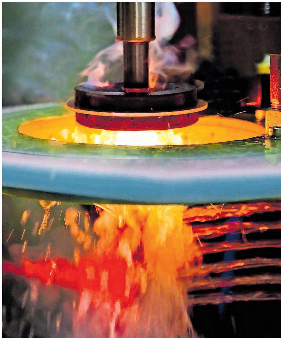
Beim Härten von verschleißresistenten Bauteilen lassen sich dank eines Managementsystems bis zu 20 Prozent Energie sparen. Foto: oh
