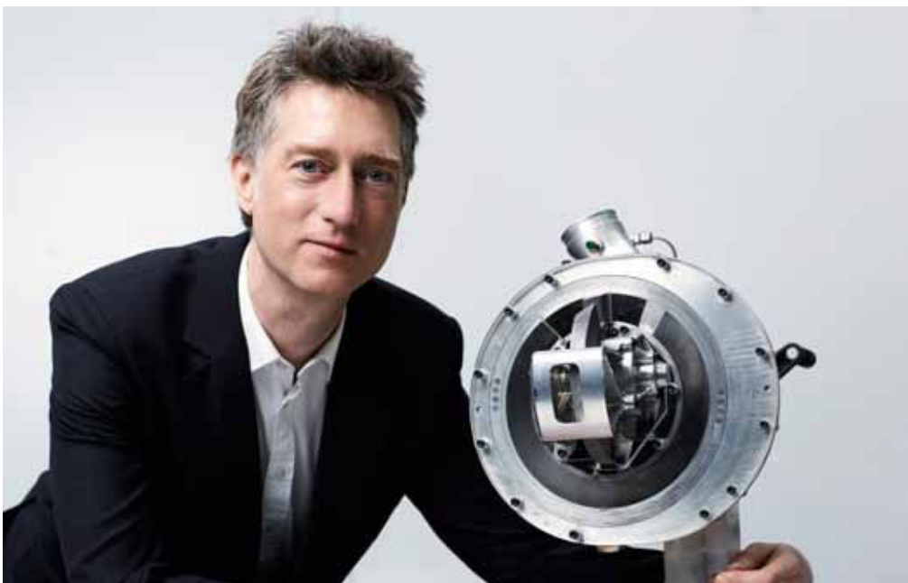
Der Blade-Kompressor von Steve Lindsey spart mehr als 20 Prozent Energie ein. Der von ihm entwickelte Kompressor kommt mit einer einzelnen im Kreis bewegten Klinge aus.
