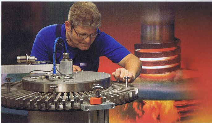
Bild 2. Beim Härten lassen sich bis zu 20 % Energie dank des Managementsystems einsparen – zum Beispiel an einer Schraubenhärteanlage.
